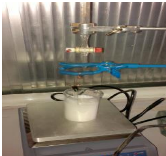
شكل (1) طريقة ترسيب الحمام الكيميائي (CBD).
