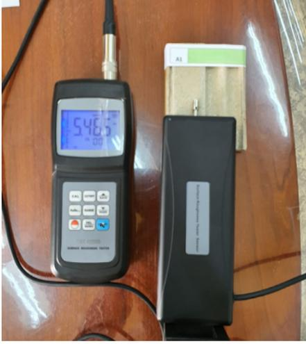
شكل رقم (٥) جهاز قياس خشونه السطح
