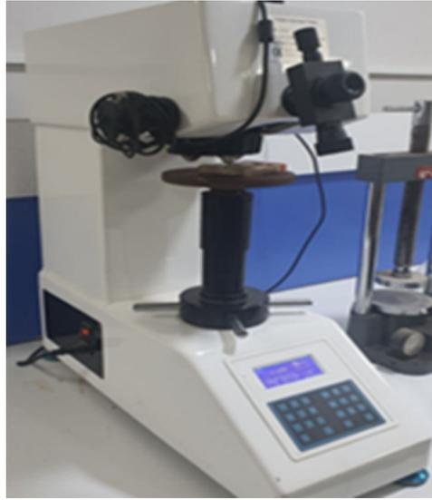
شكل رقم (٦) جهاز قياس صلادة سطح الزجاج
