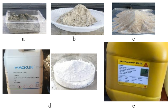
Figure 1. a) OPC, b) FA, c) Ottawa Sand, d) Nano \text{TiO}_2 , e) Viscocrete (HRWR)
