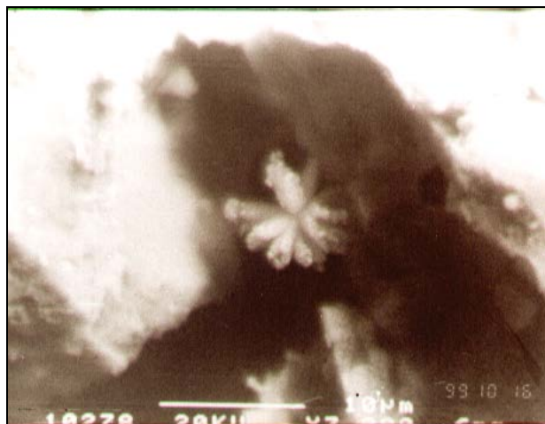
شكل (8): عينة من النموذج (K 1 ) توضح الطور الزجاجي (1000 X)
