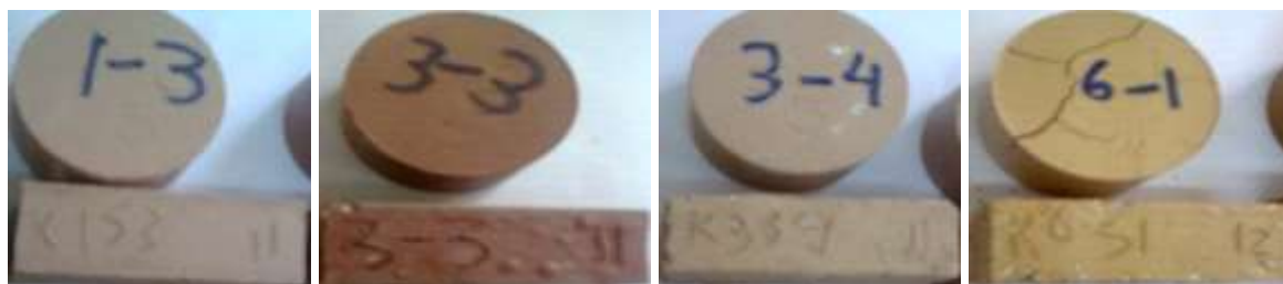
شكل 14: نماذج محضرة بالبيثق والكبس تم حرقها بدرجة (1100) °م
