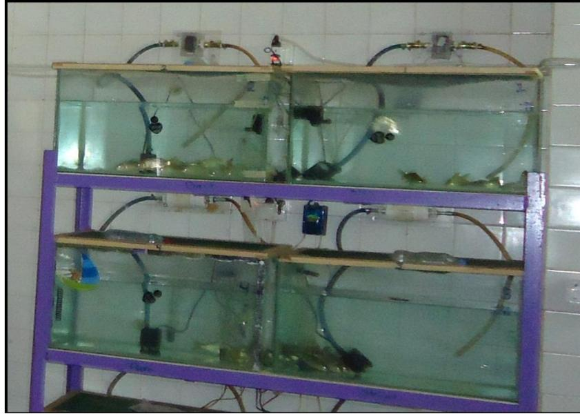
شكل 1: مكونات الأحواض المستعملة في التجربة المجهزة بماء ممغظ.
