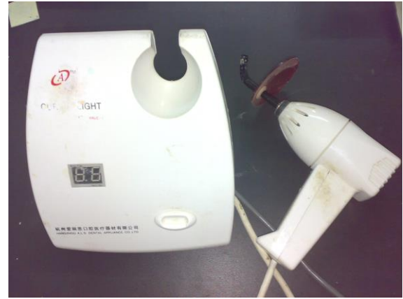
صورة ١: توضيح جهاز تصلب الحشوة الضوئية.
