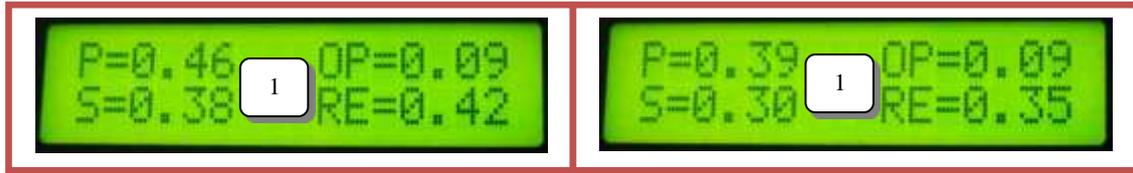
نلاحظ في الشكل (16) إن نقطة التقاطع بين تيارى التشغيل والكبح تقع خارج منطقة العمل للمرحلة التفاضلية بحسب خصائص ميل منطقة التشغيل، لذا لاتعمل المرحلة التفاضلية وتبقى المحولة بالعمل.
