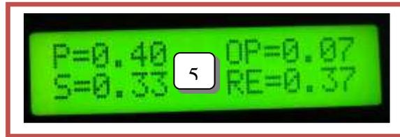
نلاحظ في الشكل (12) أن نقطة التقاطع بين تيار التشغيل والكبح تقع خارج منطقة العمل للمرحلة التفاضلية بحسب خصائص ميل منطقة التشغيل، لذا لا تعمل المرحلة التفاضلية وتبقى المحولة بالعمل.
