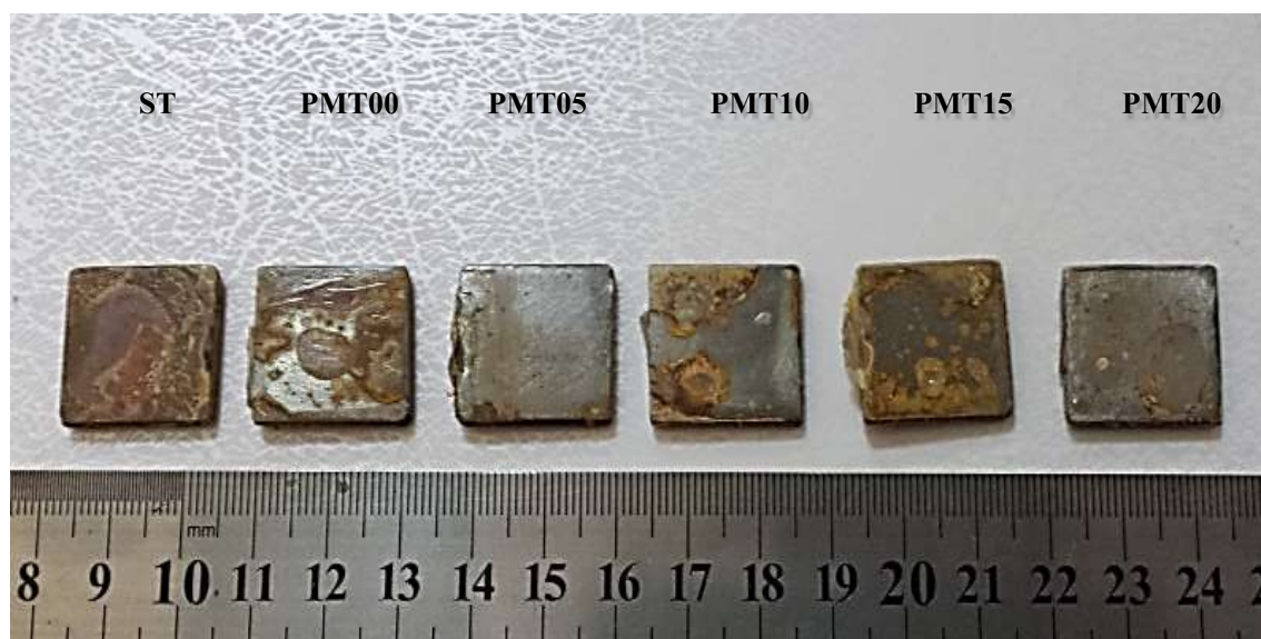
الشكل (10) صور لسطح النماذج بعد التآكل في محلول 5% NaCl
