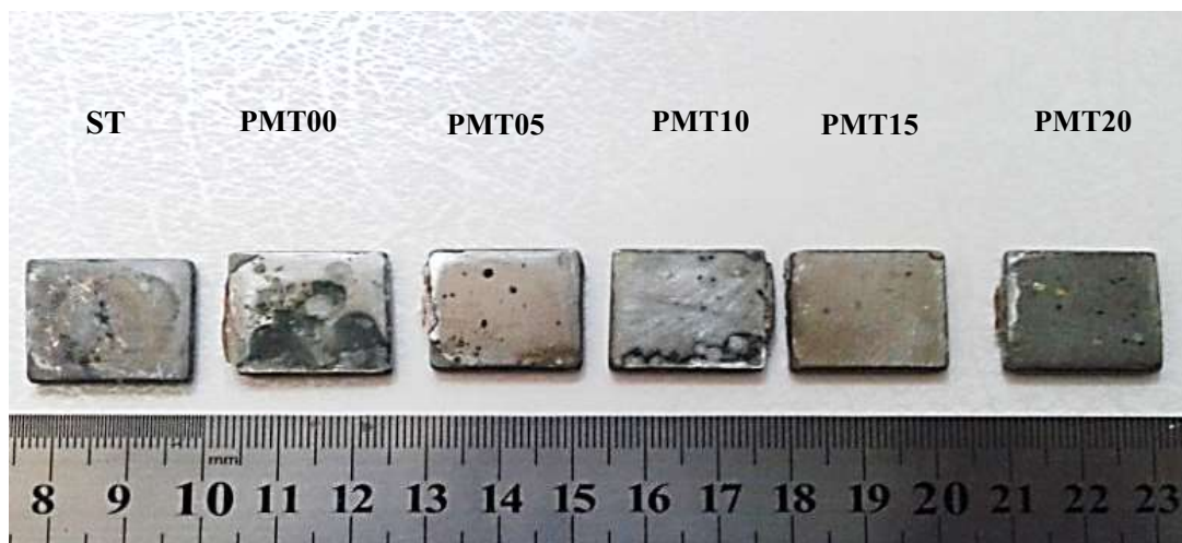
الشكل (9) صور لسطح النماذج بعد التآكل في محلول 1N HCl
