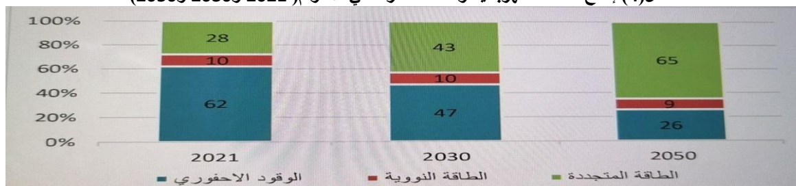
الشكل (4) إنتاج الطاقة الكهربائية وفقاً لمصادرها في الأعوام (2021 و 2030 و 2050)
