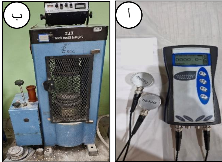
الشكل 5. الأجهزة المستخدمة في الفحوصات الميكانيكية (أ) فحص السرعة الموجية (Ultrasonic pulse velocity)، (ب) فحص مقاومة الانضغاط غير المحصور (Uniaxial compressive strength).
