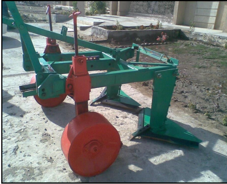
شكل ١: منظر جانبي للمحراث التحتي المحور محلياً (Sweep plow)
