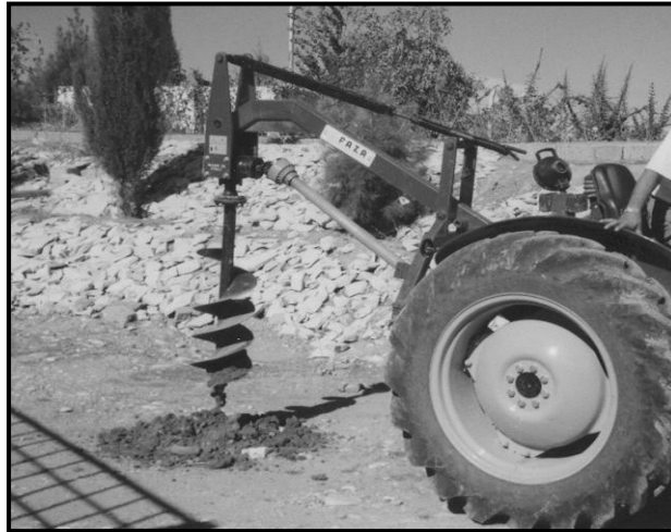
شكل 1: آلة الحفر - تعمل ب PTO.
