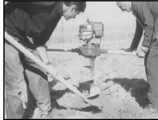
شكل 2: آلة الحفر -تعمل بالوقود.
