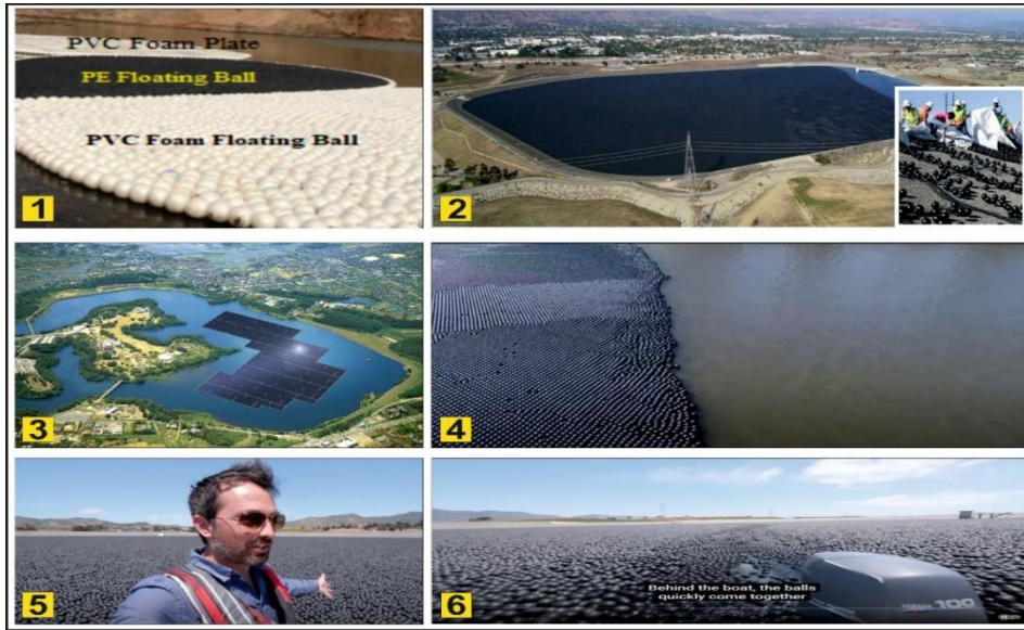
الشكل (9) استخدام الكرات والأغطية البلاستيكية العائمة لتقليل التبخر من البحيرات
