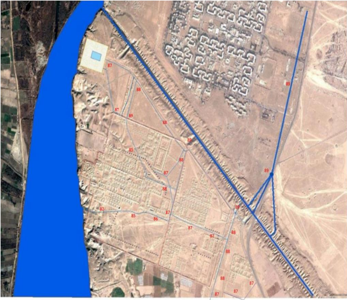
مخطط رقم (1) يوضح ارتفاع وانخفاض سواقي نظام الارواء عن مستوى سطح البحر في مجمع قصور الخلافة
