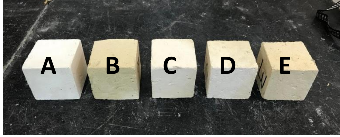
شكل رقم (٣) نماذج خلطات المونة المصنعة بعد الحرق
