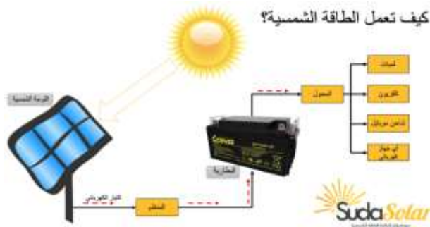
شكل (4) يوضح كيفية عمل الطاقة الشمسية عن طريق الألواح الشمسية
