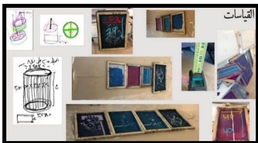
شكل (24) ضبط مقاسات التصميم على القماش لتحديد الشاشات والقماش للطباعة
