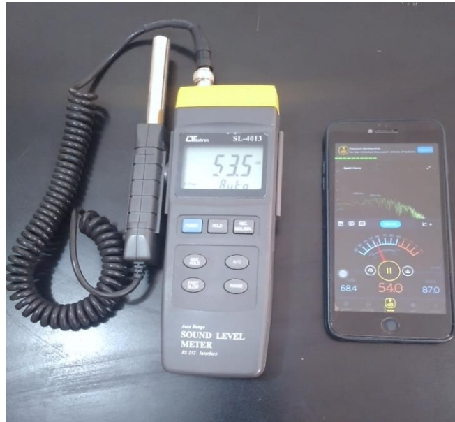
الشكل (٣): معايرة التطبيق (Decibel X) مع جهاز (Lutron SL-4013).
