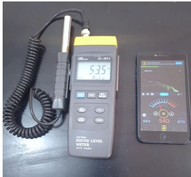
الشكل (٣): معايرة التطبيق (Decibel X) مع جهاز (Lutron SL-4013).
