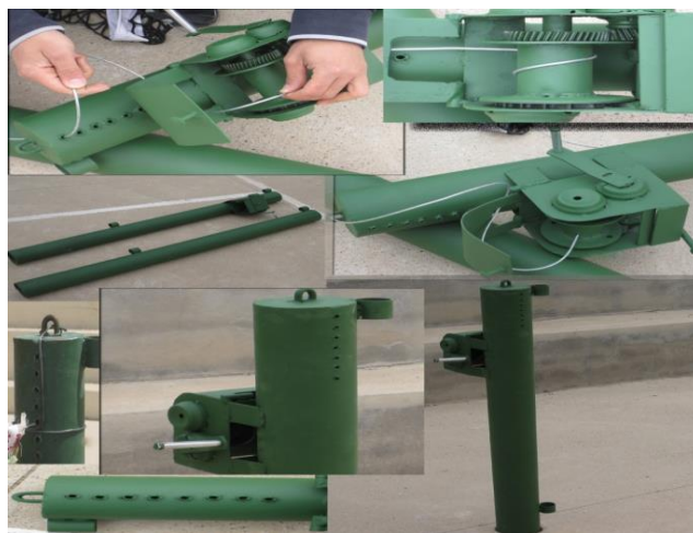
صورة (2) توضح العمود الحامل للشبكة (Post) بارتفاعات مختلفة
