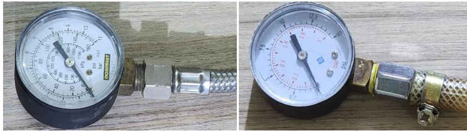
(أ). مقياس ضغط الماء لحد 1 بار (ب). مقياس ضغط الماء لحد 11 بار
