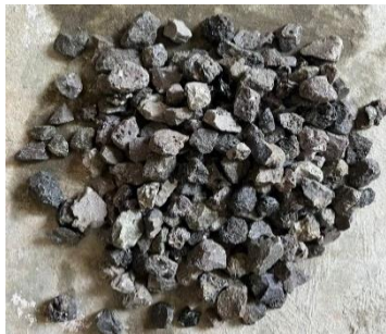
Fig. 1a. Steel slag
