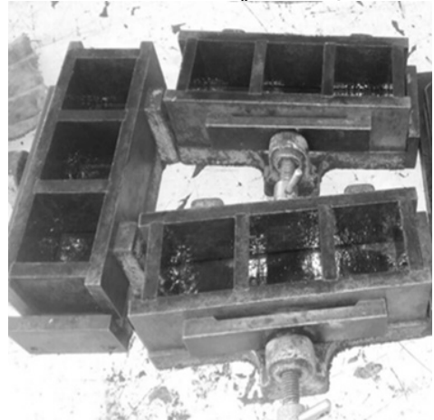
شكل (1): قوالب فحص مقاومة الانضغاط ومقاومة الانثناء
