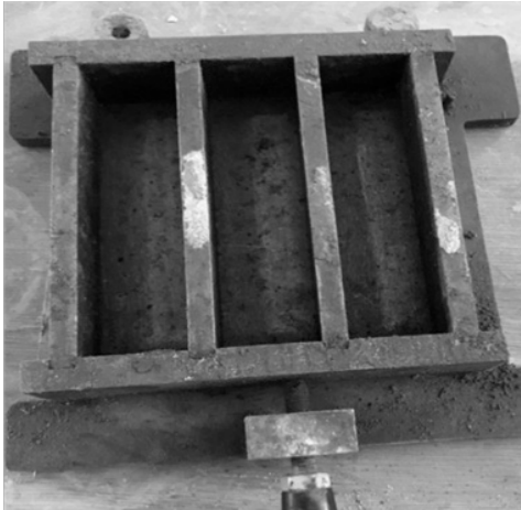
شكل (1): قوالب فحص مقاومة الانضغاط ومقاومة الانثناء
